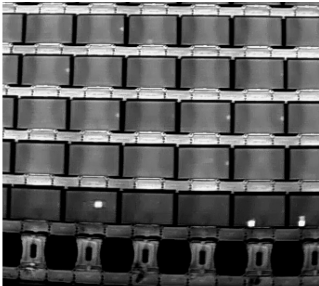
写真-7.4.4 水上発電所検査時のIR画像 出典）エナジー・ソリューションズ
